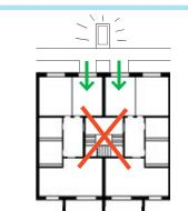
Die inneren Treppenhäuser der Gebäude vom Typ P2 werden abgerissen, der frei werdende Raum den Wohnungen zugeschlagen. Die neue Erschließung übernimmt ein außenliegender Laubengang, der zugleich eine effiziente Ausnutzung neuzubauender Aufzüge ermöglicht.
